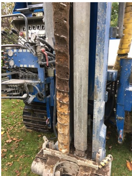
Figur 6. Foto på borkärna 16ÅF03, 0-1 m. Foto: ÅF Infrastructure AB
